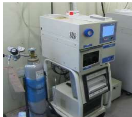
明治市民センター局 二酸化硫黄・浮遊粒子状物質計
