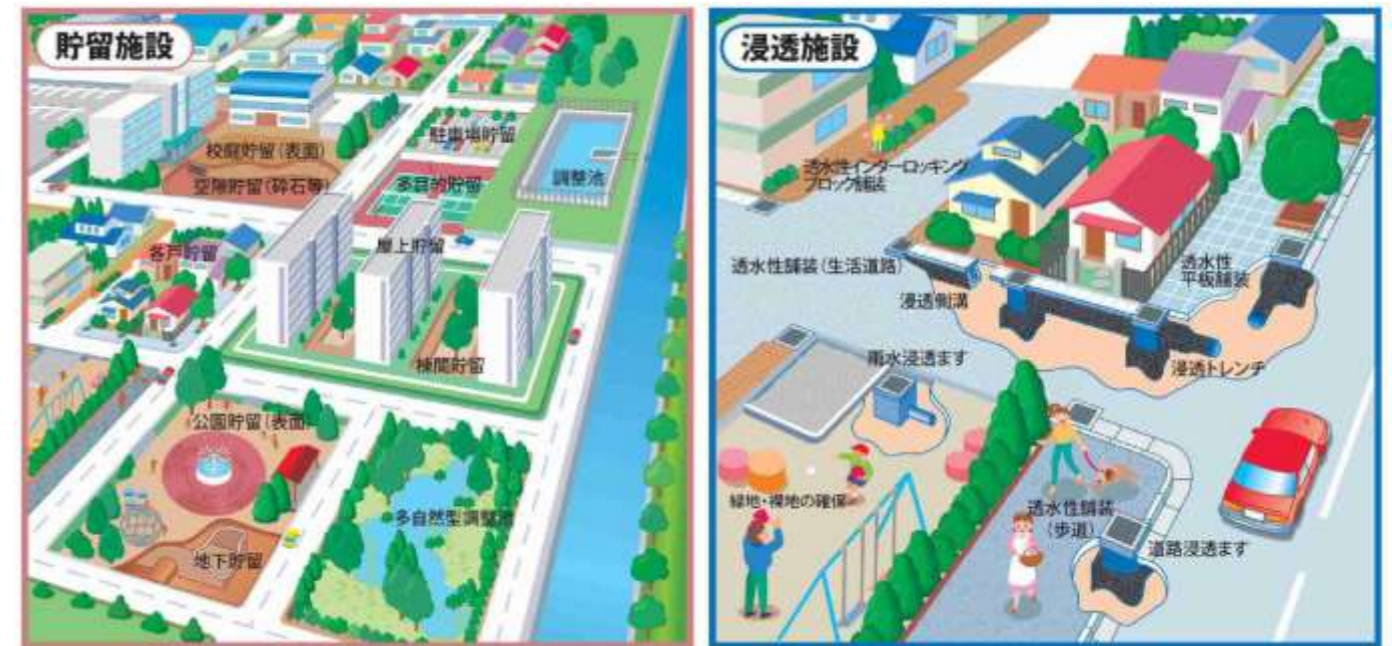
まちづくりに活用される雨水貯留浸透施設のイメージ（公益社団法人雨水貯留浸透技術協会資料より）
